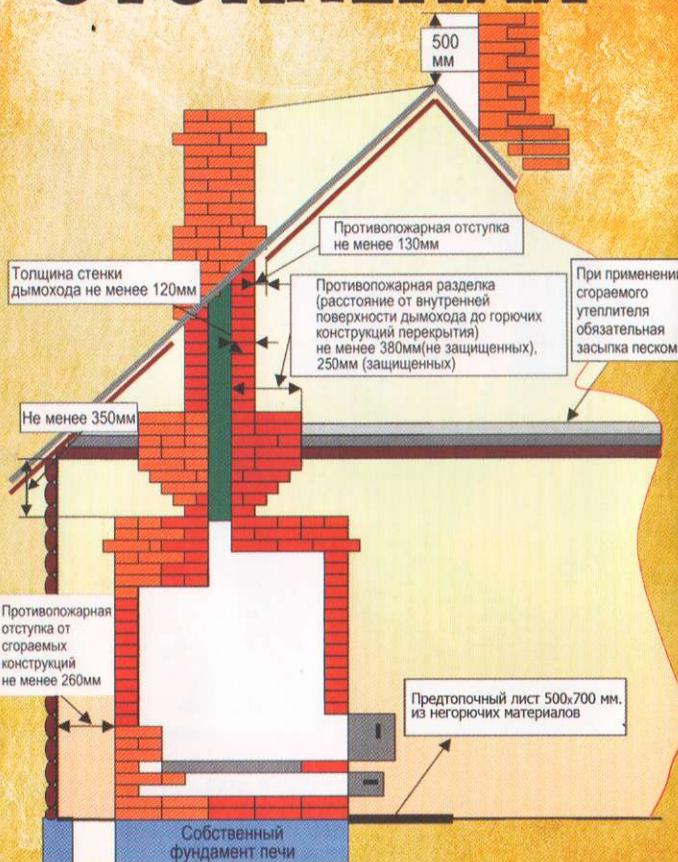
между стенами печи и деревянными конструкциями должен оставаться воздушный промежуток - отступка печь и дымовая труба в местах соединения с деревянными перекрытиями должны иметь утолщения кирпичной кладки - разделку
